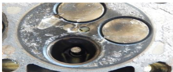
Slika 8. Pogled na oštećenu glavu motora, oštećeno sedište ventila i polomljen izduvni ventil na šestom cilindru motora
