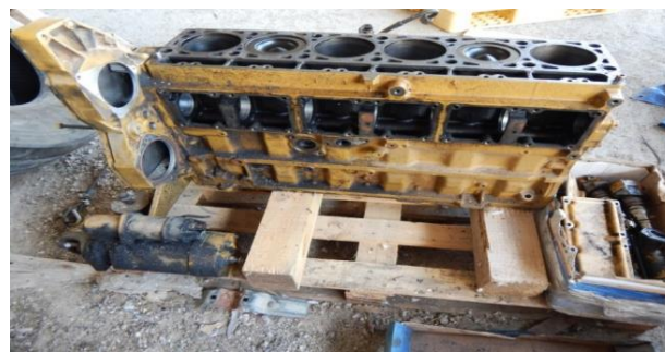
Slika 2. Na bloku motora nema vidnih oštećenja
