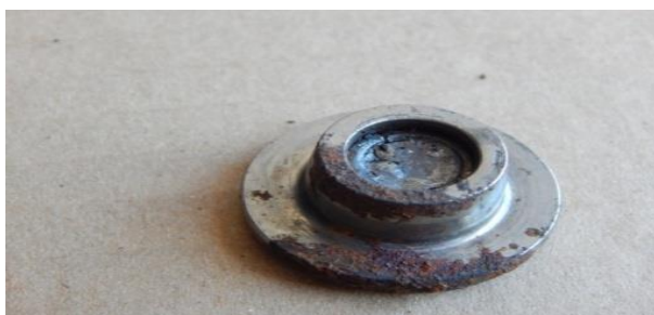
Slika 9. Pogled na oštećen - polomljen deo stabla izduvnog ventila na šestom cilindru sa svojim osiguračem u svom repnom delu pogonskog motora
