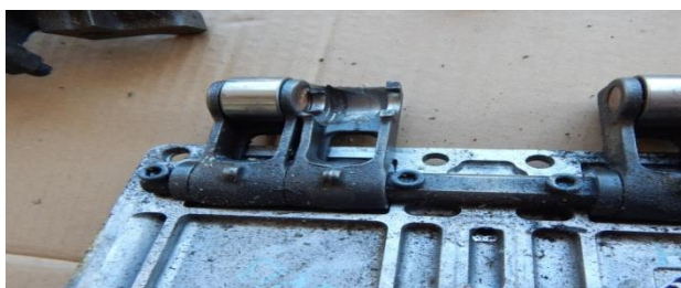
Slika 5. Pogled na oštećeno ležište rolnice koja usmerava kretanje šipke podizača šestog izduvnog ventila pogonskog motora
