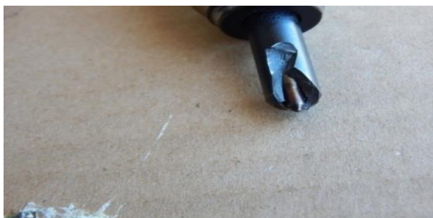
Slika 15. Oštećen brizgač - injektor šestog cilindra motora
