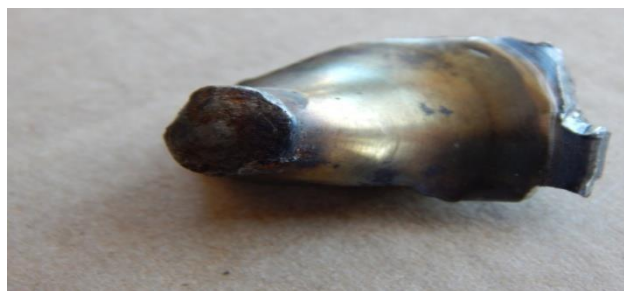
Slika 10. Polomljeni deo izduvnog ventila - pečurke ventila na šestom cilindru pogonskog motora
