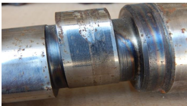
Slika 3. Oštećena je bregasta osovina na mestu šetog izduvnog ventila
