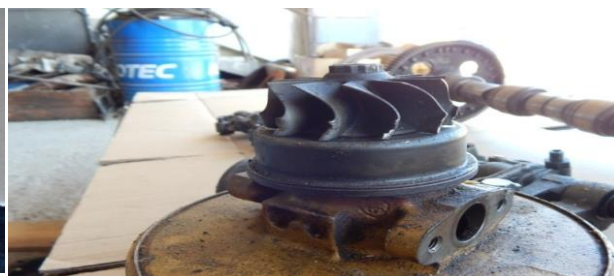
Slika 12. Oštećene lopatice turbine motora
