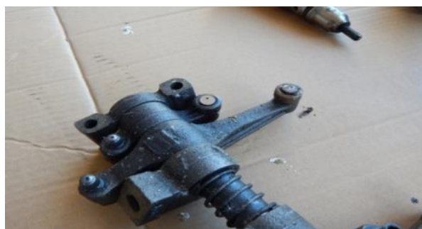
Slika 4. Pogled na klackalicu koja dodiruje glavu iznad šestog cilindra motora drobilice za drvo - povećan zazor koji omogućuje i aksijalno pomeranje i klaćenje klackalice šestog izduvnog ventila
