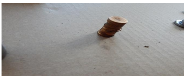
Slika 7. Pogled na oštećenu osovnicu rolnice koja usmerava kretanje šipke podizača šestog izduvnog ventila motora
