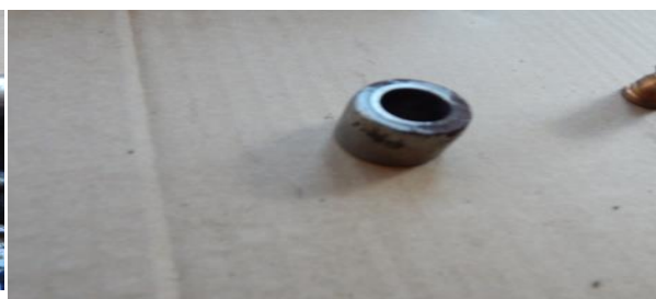
Slika 6. Pogled na oštećenu rolnicu koja usmerava kretanje šipke podizača šestog izduvnog ventila motora
