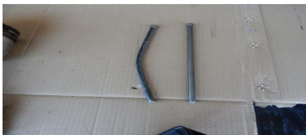
Slika 11. Deformisana šipka podizača izduvnog ventila na šestom cilindru motora pored nedeformisane
