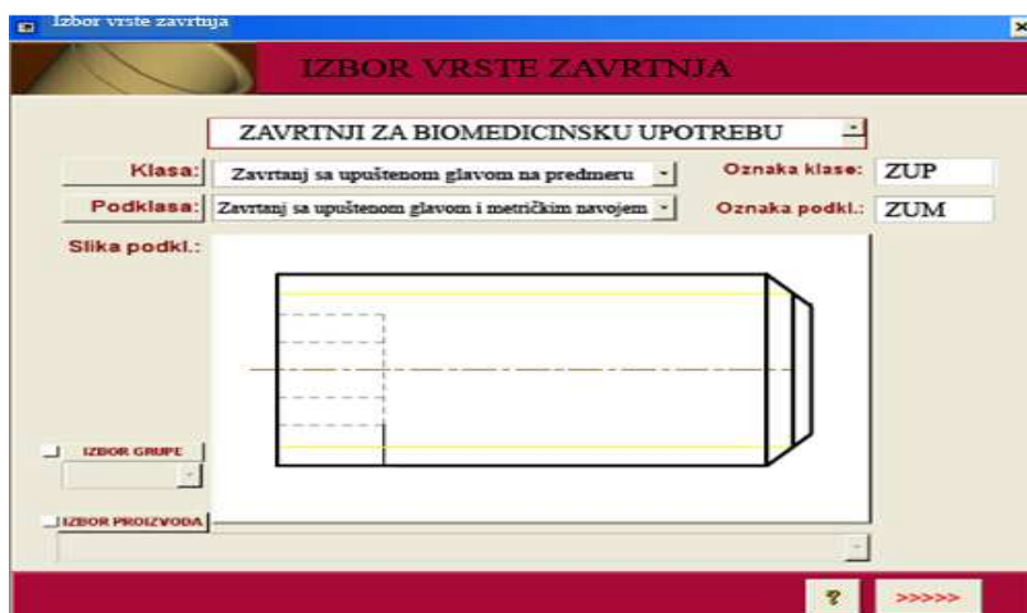
Slika 1. Interaktivna klasifikacija zavrtnja za biomedicinsku upotrebu na bazi geometrijskih parametara i njegova vizuelna identifikacija
