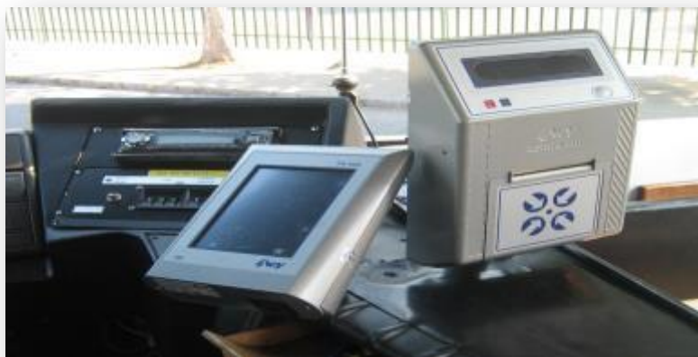
Slika 2. Stabilni aparat TA 400 s terminalom BT3 u vozilu [1]
